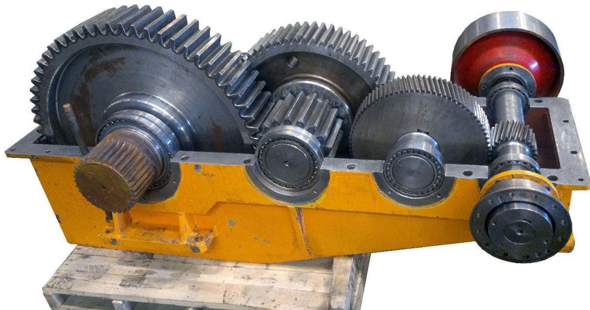
گیربکس ترکیبی مربوط به آسیاب دوار افقی (یک گیربکس تیپ BEVEL-HELICAL به همراه گیربکس کمکی)
