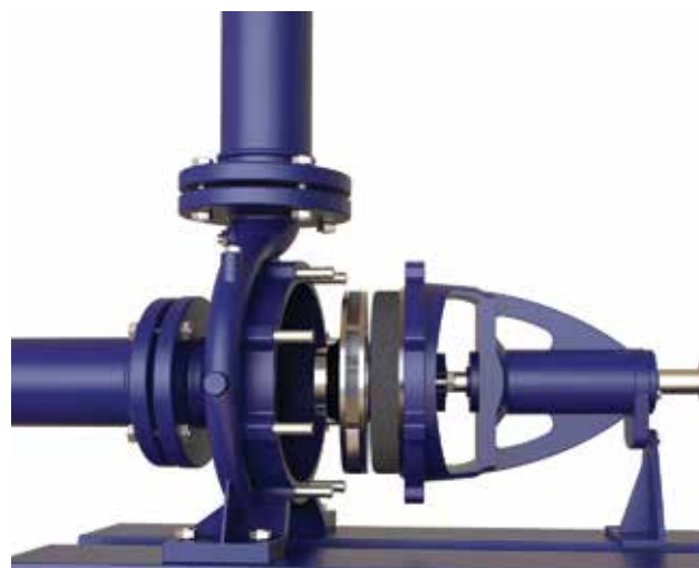
شکل ۱۹- بیرون کشیدن پایه یاتاقان
